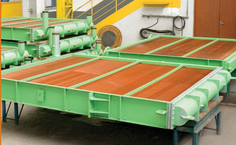
Esse modelo de trocador é utilizado para resfriamento de ar mediante água. O ar quente passa externamente pelas aletas e a água circula internamente pelos tubos, não havendo contato entre os fluidos. As aletas são lâminas de pequena espessura, com perfil senoidal, que formarão juntamente com os tubos, um bloco aletado rígido que impossibilita a vibração do conjunto pela passagem externa (entre aletas) do ar.
