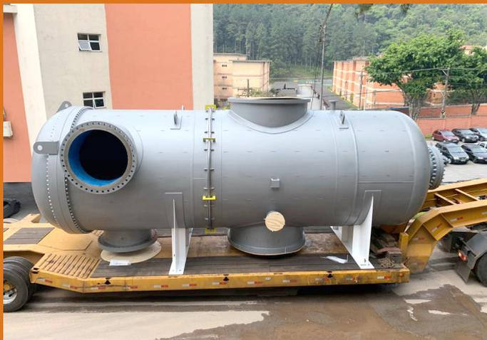
Vasos de pressão são equipamentos que contém fluidos sob pressão interna. Esses equipamentos podem conter líquidos, gases ou misturas destes, sendo alguns deles especiais, como:  $H_2$ ,  $H_2S$ , Oxigênio, etc.
