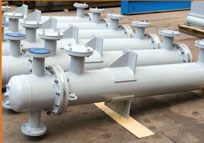
Os trocadores de calor para resfriamento de óleo de transformadores de potência a água são fabricados na forma construtiva tipo casco e tubos, onde a água circula pelos tubos e o óleo pelo casco. Neste caso, são fabricados com feixe tubular deslizante, permitindo a limpeza e manutenção dos circuitos de água e óleo.
