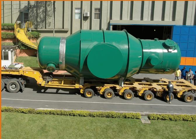
Os condensadores de superfície são trocadores de calor do tipo casco e tubos, projetados essencialmente para condensar vapor sob vácuo na exaustão de turbinas a vapor, de modo a aumentar a eficiência da turbina. Podemos fornecer tanto o condensador sozinho, como o sistema de condensação completo. O sistema de condensação pode acompanhar os seguintes itens:
