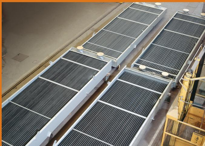
Os radiadores aletados normalmente são utilizados para aquecimento de ar. Nestes casos, o ar passa externamente pelo lado aletado e o fluido de aquecimento circula internamente através dos tubos, não havendo contato entre eles.
